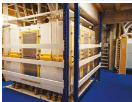
Der Plansichter sorgt für die Trennung von Kleie und verschiedenen Mehlkörnungen
