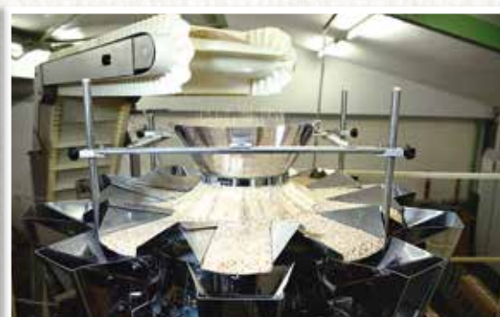
Mehrkopfwaage für genaues Dosieren in der Abpackung
